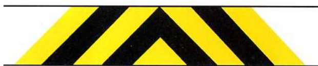
图 A.2 以设备中心为轴线对称的相间条纹示意图
