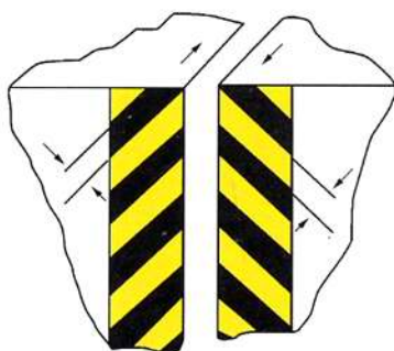
图 A.3 相对运动棱边上条纹的倾斜方向示意图
